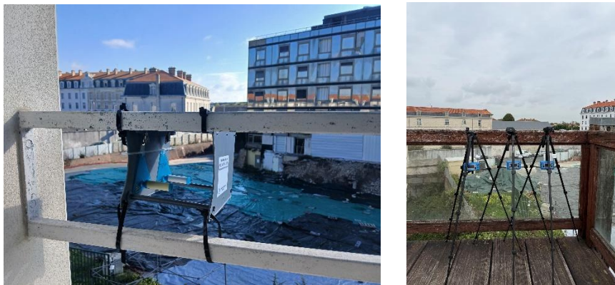
Figure 3 : Illustrations des dispositifs mis en place (à gauche : prélèvements passifs / à droite : prélèvements actifs)
