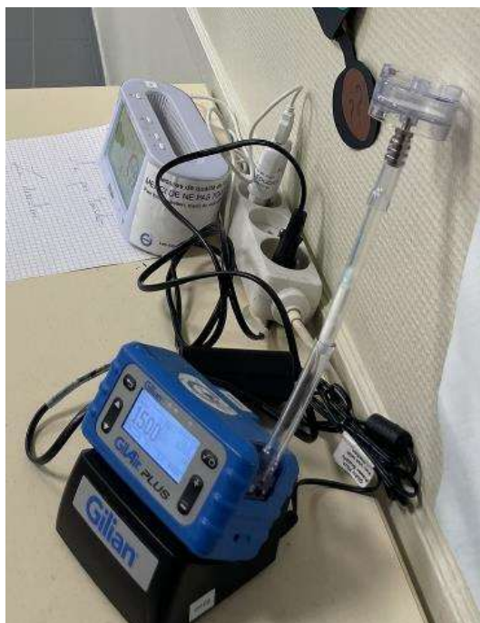
Figure 2 - Pompe bas débit avec cassette et cartouche pour le prélèvement des HAP (fraction particulaire et fraction gazeuse)
